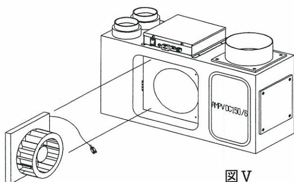
③メンテナンスカバーを外すと中に点検扉が見えます。点検扉は向かって右上下角の2個所でビス固定しています。2個所のビスをプラスドライバーで外してください。点検扉が開く状態になります。扉を開くとファン本体が手前に出てきます(図 II、図 III)。
